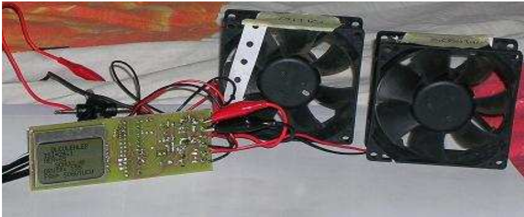
Şekil 10. PIC kontrol devresinin genel görünümü
